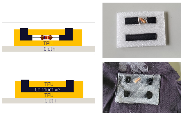
図 5 回路を内蔵したアップリケ型デバイス
