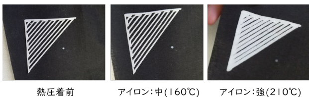
図 2 PLA のアイロンを用いた熱圧着
