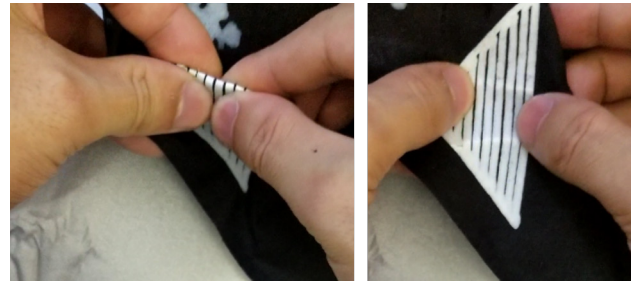
図 3 熱圧着後の剥がれ・割れ耐性
