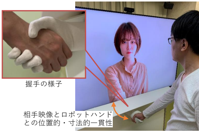
図1 等身大のビデオ通話における相手映像とロボットハンドとの位置的・寸法的一貫性
