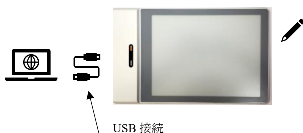
図 1 電子ペーパーとコンピュータの接続
