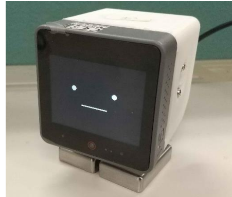
図 2. 制作した M5Stack CoreS3 を用いたスタックチャン
