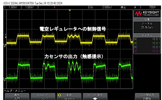
図 8 \phi 65\text{mm} の円柱に 2N 力印加のオンオフをしている際の電空レギュレータへの制御信ステップ (黄色の信号) と力センサ出力 (緑色の信号)
