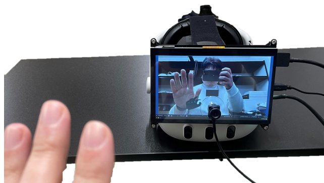
図 1 本研究のコンセプト。HMD（Meta Quest3）前面に取り付けられたディスプレイおよび web カメラより外部の映像を取得し、相対するユーザーは HMD ユーザーとハンドトラッキングを用いたインタラクションを行う。
