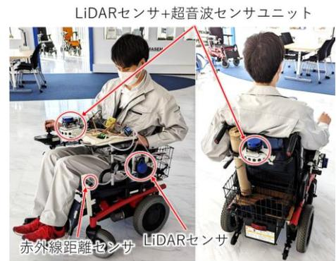
図 11 電動車いすに安全装置を搭載した様子
