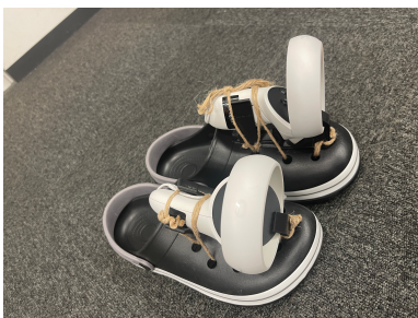
図 1 実験で用いた装置（VR コントローラと 3D プリントアタッチメントの固定例）
