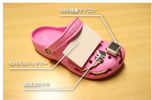
図4 非接触式皮膚温計測スリッパの構成
