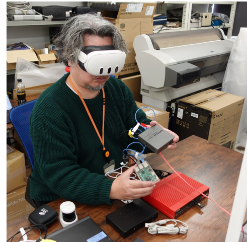
図 6: デモアプリケーションをインストールした Meta Quest 3 を装着し作業支援を受けつつネットワーク構築作業を実施
