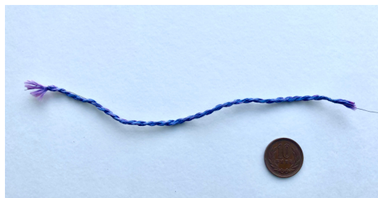
図 16 サーモクロミック組紐
