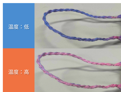
図 17 ニクロム線の温度と組紐の色変化
